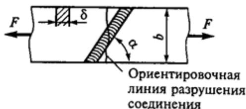
Рис. 9. Косой стыковой шов
