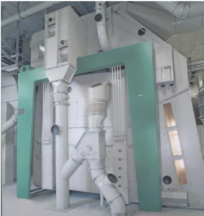
Рис. 4. Внешний вид и функциональная схема зерноочищающей машины серии Schmidt-Seeger TAS™
